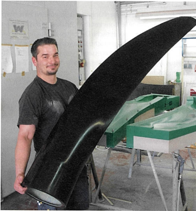
BILD 2 Unbearbeiteter Flügel mit einem Gewicht von circa 27,5 kg, im Hintergrund sind die Negativformen aus Toolingmaterial zu sehen
